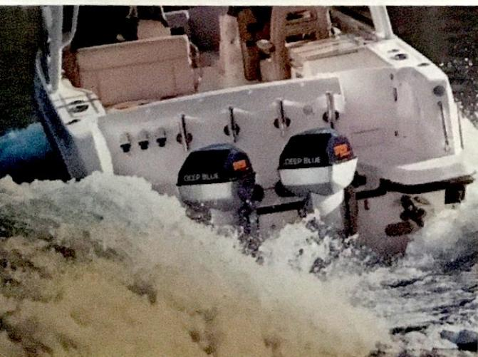
► *Torqueedo, azienda leader nel campo delle motorizzazioni elettriche per la nautica, attualmente offre soluzioni entro bordo e fuoribordo fino ad una potenza nominale di 80cv. L'applicazione sulle imbarcazioni da diporto è ancora limitante a causa dell'autonomia esigua, ma i valori di coppia e di efficienza rendono questa tecnologia foriera di interessanti sorprese per il prossimo futuro.*
