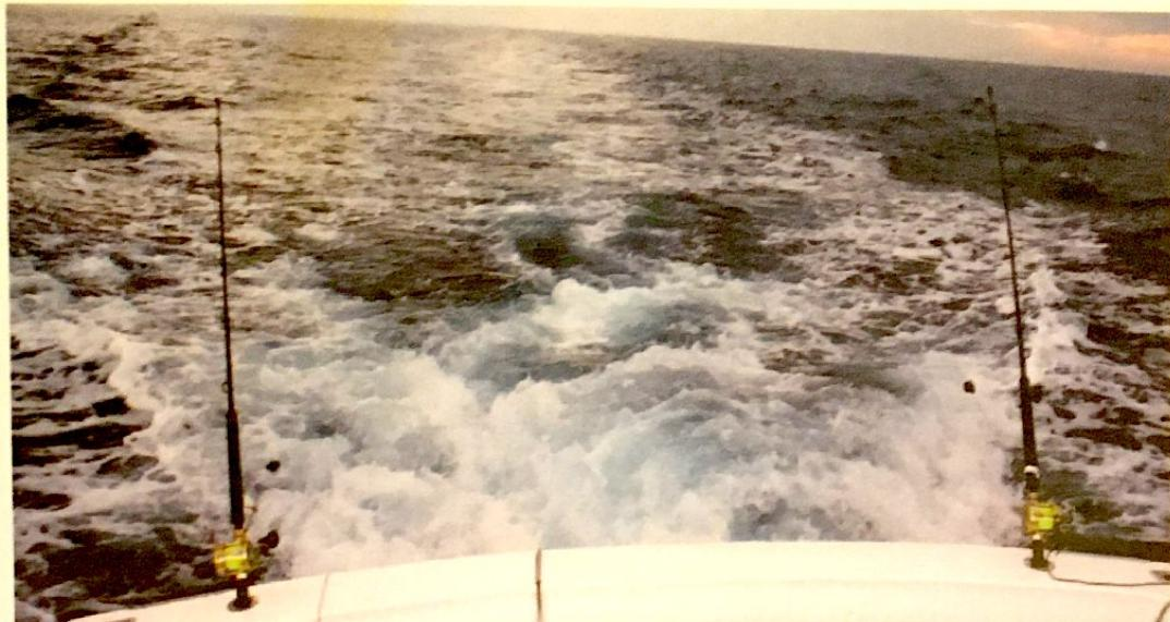
► La scia di una imbarcazione entrobordo in linea d'asse. Notare i chiari ai margini dell'acqua dura spinta dalle eliche e la regolarità delle onde di dislocamento, che derivano dal beccheggio e dall'importanza dell'opera viva. A lato un fisherman spinto da una motorizzazione fuoribordo multipla.
