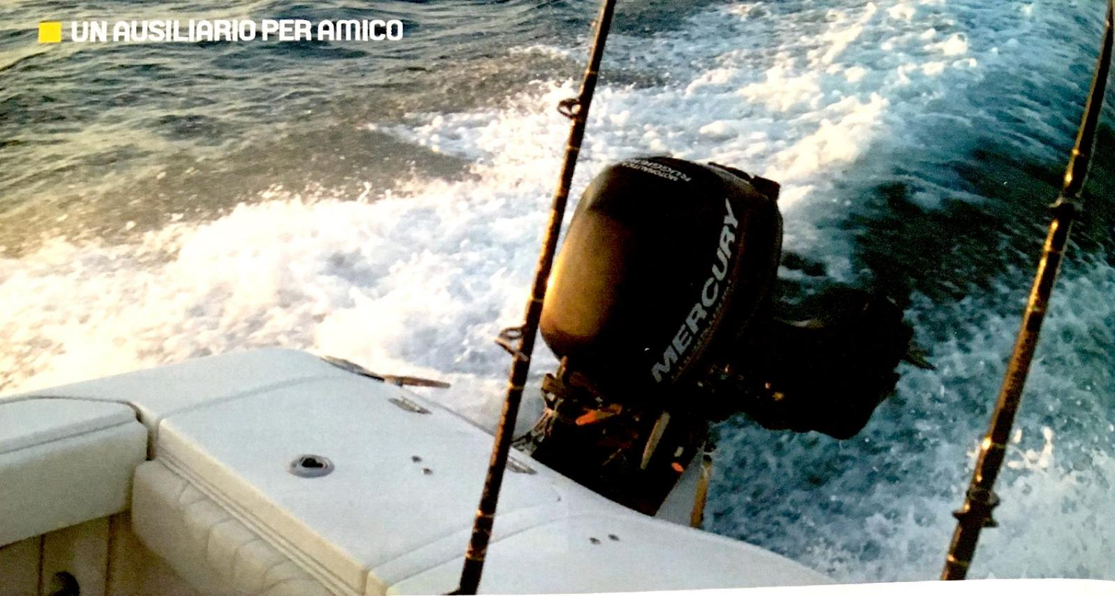
► *Un piccolo fuoribordo ausiliario può essere montato su qualsiasi imbarcazione a prescindere dal tipo di motorizzazione principale. La potenza va scelta in base alle caratteristiche dell'imbarcazione e alle proprie esigenze, tenendo presente che c'è anche chi ha montato un ausiliario da 20 Cv su un gommone di sei metri per garantirsi un rientro sicuro in caso di avaria.*
