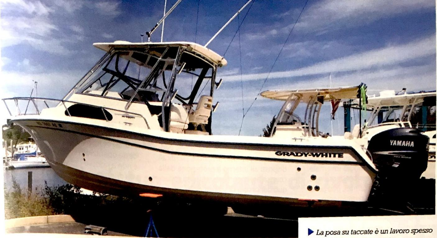
profrescenze, che sarà poi possibile rimuovere con una spazzola a setole mentre da passare con moderato vigore sulle parti da nettare. Nel mettere la barca in secco occhio però alla corretta posa sulle taccature: puntellare la barca in punti dello scafo delicati può costarvi molto caro dopo mesi di sosta!
