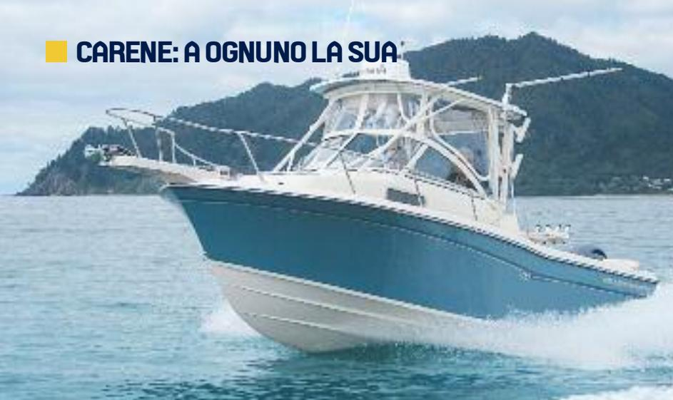
Un deadrise generoso, poi, assicura stabilità e direzionalità alle andature medio-alte, limitando al massimo la perdita di contatto dei piani di carena con la superficie del mare. Questo direttamente si trasmette in una propulsività omogenea, in quanto assicura costante contatto delle eliche con acqua "dura", e dunque, tirando le somme, il Carolina Hull sembra proprio il design adatto ai mari "tosti", tipici dell'Atlantico.
