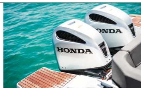
► Honda mantiene lo schema tradizionale del V6 3.0L ad aspirazione naturale e iniezione elettronica, implementato dalla fasatura variabile. Affidabilità comprovata da un progetto ampiamente collaudato.
